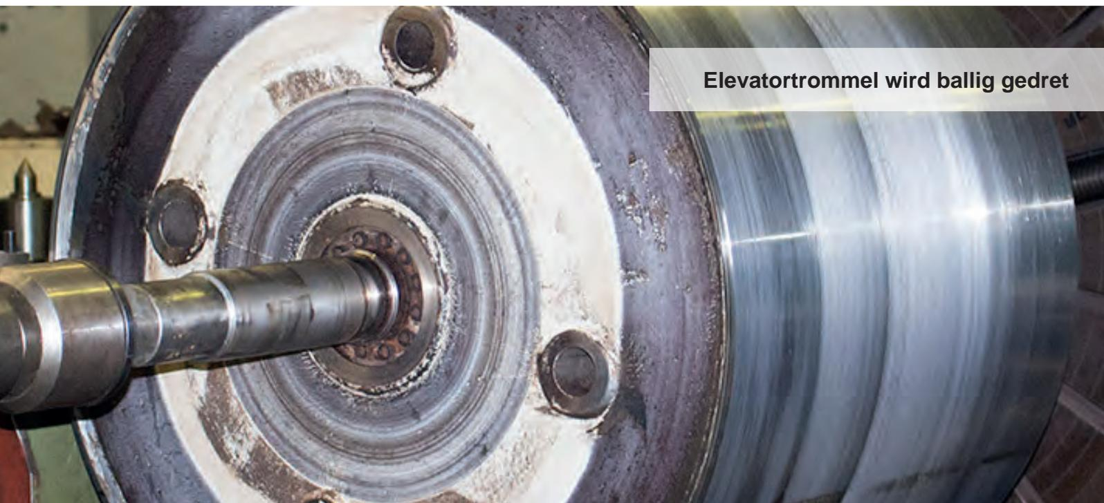
Elevatortrommel wird ballig gedret
