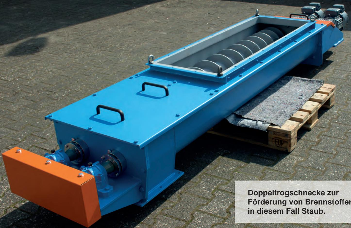
Doppeltrogsschnecke zur Förderung von Brennstoffen in diesem Fall Staub.
