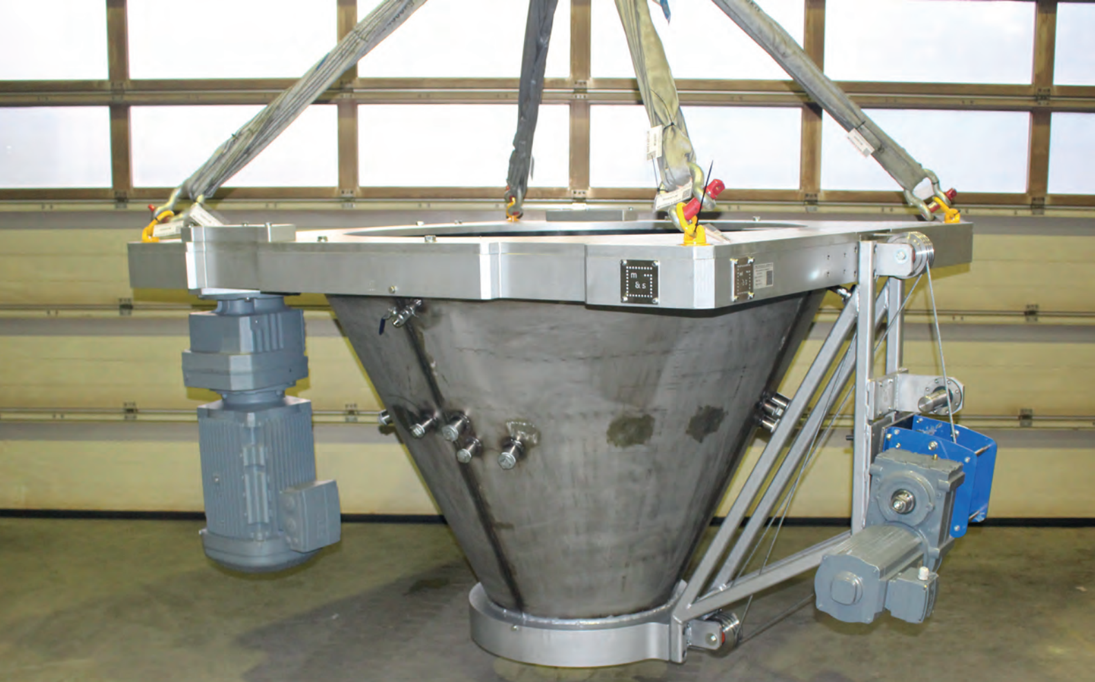
Fallschachtbeleimung mit optimierter Kühlung des Mantels, der Räumarm ist oben und unten geführt
